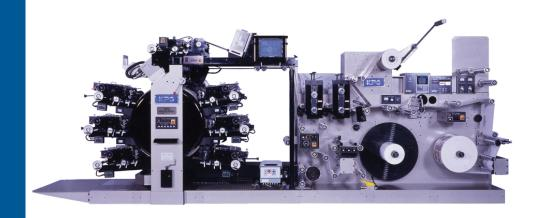
KPGの凸版輪転ラベル印刷機には、多種多様なラベル製造を可能にするコールドフォイル、ホットスタンプ、ウエットラミネート、スリッター、コロナ装置、チルローラーなどの各種オプション装置が用意されております。また、RFIDアプリケーターや可変情報印字機などとの組み合わせも可能です。
