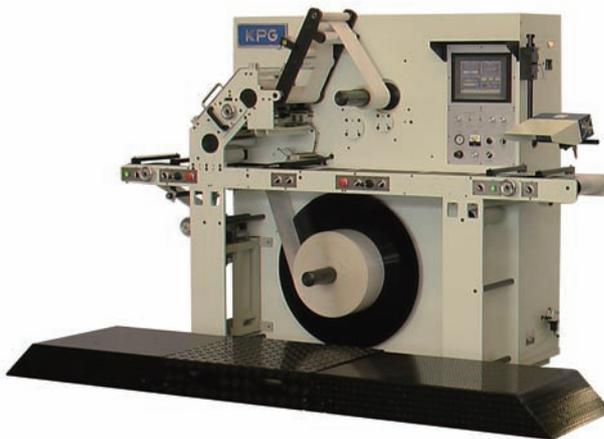
KPGラベル検品・スリッター機は最高速度毎分200mで最大10列までの検品作業と最大11列(標準7列)までのスリット作業が1台で行える装置です。ラベル抜けやカス残り、紙つなぎテープなどを感知し、異常があった場合にはスリット作業を行う手前で機械を停止し、タッチパネルにエラーの状態を表示します。
