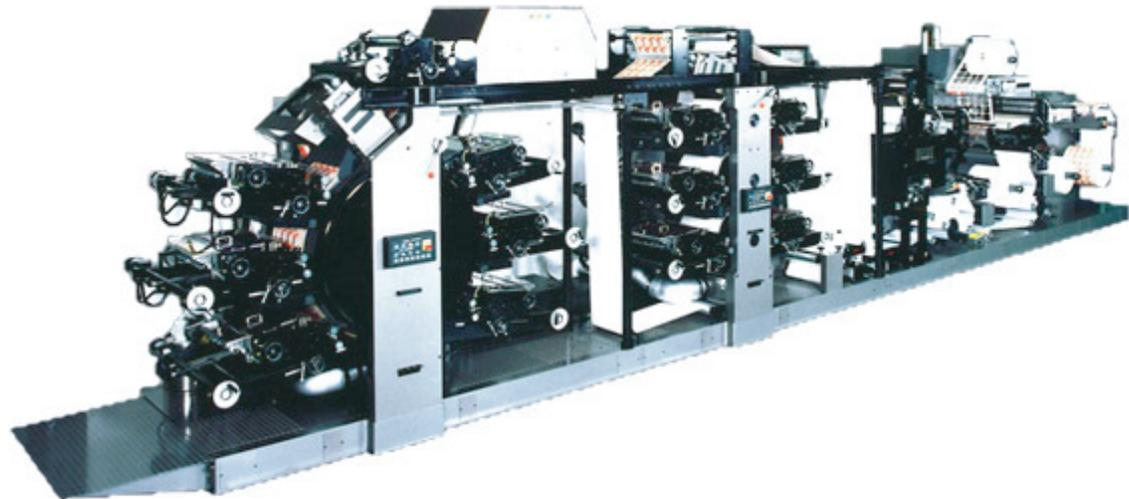
KPGのクーポンラベル印刷機では表印刷、裏面印刷、糊面印刷ができ、折り装置、ドライラミネート装置、ホットメルト塗工装置が装備され、最大9ページまでのブックレットラベル、ピギーバックラベル、ネックハンガー等のラベルがワンパスで製造できます。
