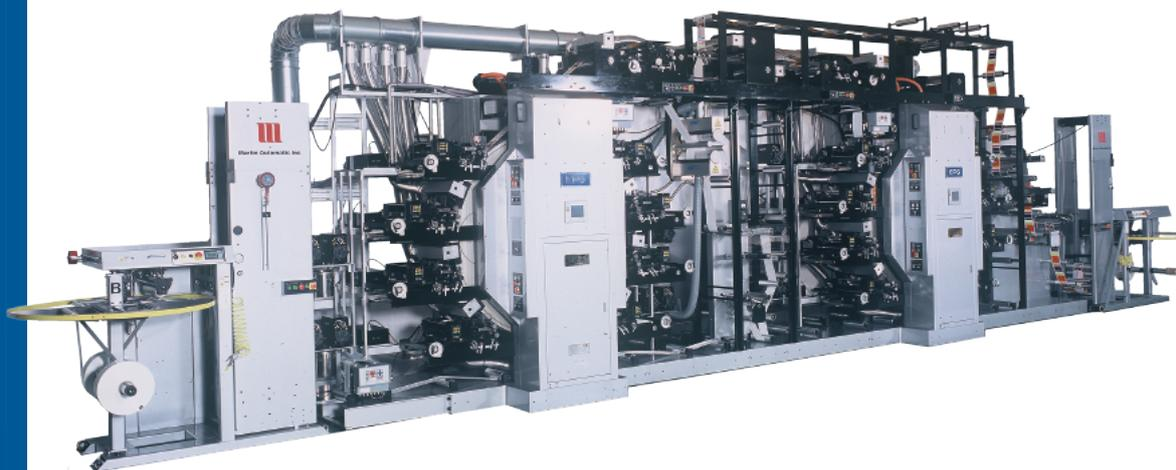
KPGのUVフレキソ・ケーシング印刷機は最大16色の印刷が可能で、ニス引き装置も最大で2台搭載することができます。センタードラム、冷却装置、ACサーボ張り力制御機構を採用しているため、フィルム等の伸びる素材で安定した見当精度を保つことができます。また、ヤレを最小限に抑える事のできるアキュムレーターを搭載し、印刷機を止める事なく原反を交換する事も、オートスプライサーやタレットレイワインダーを装備することによって、自動で原反の交換を行う事も可能です。
